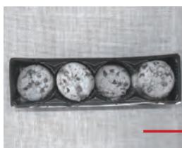
ビスケットの枚数の違いを高さ(距離)で判定
